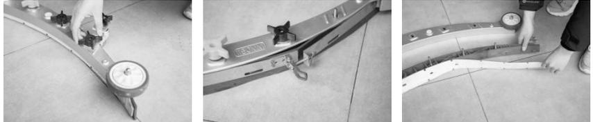
Schritt 2: Ziehen Sie den Hebel der Gummistreifen-Druckplatte nach oben und entfernen Sie die Platte.
