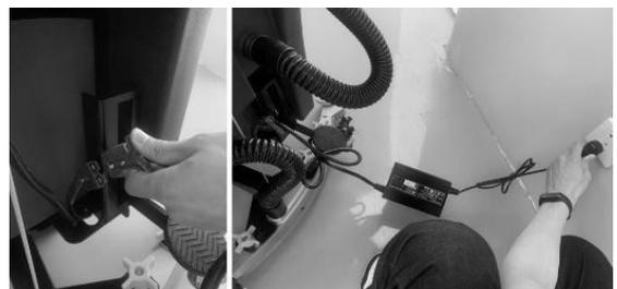
verfügt über eine Unterspannungsschutzfunktion. Wenn die Maschinenspannung unter 21 V fällt, wird die Stromversorgung automatisch unterbrochen und die Verwendung des Geräts verhindert. Laden Sie den Akku dann rechtzeitig auf und setzen Sie die Verwendung fort.
