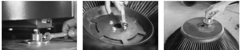
Lösen Sie die Schrauben der Seitenbürste und drücken Sie die Seitenbürste mit den Händen nach unten. Anschließend kann die Seitenbürste entfernt werden.
